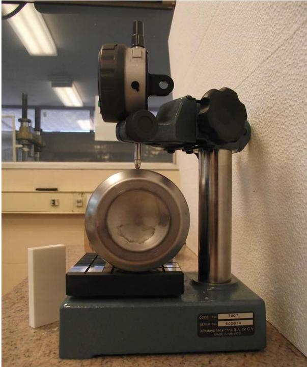
Figura 4. Medición del diámetro exterior de la campana.
