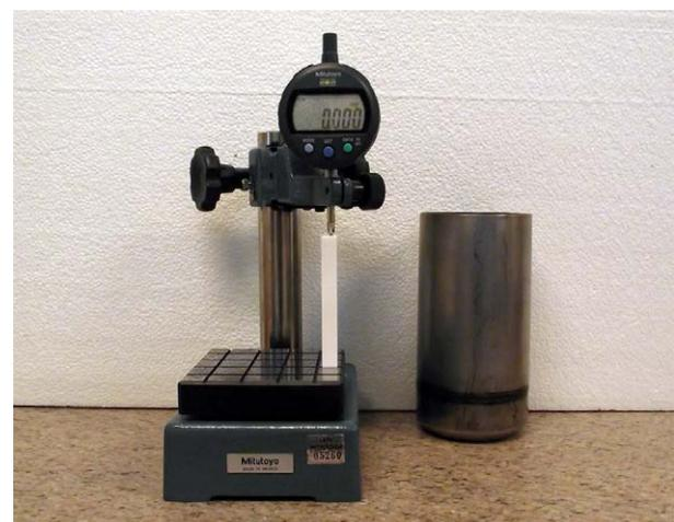
Figura 3. Ajuste de cero del comparador.
