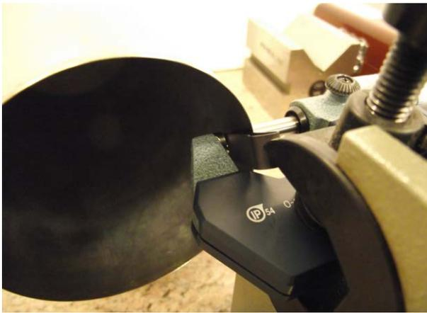
Figura 5. Medición del espesor de chapa.
