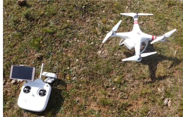
**Figura 2.** Dispositivo aéreo no tripulado (DRONE DJI - Phantom II Vision +).
